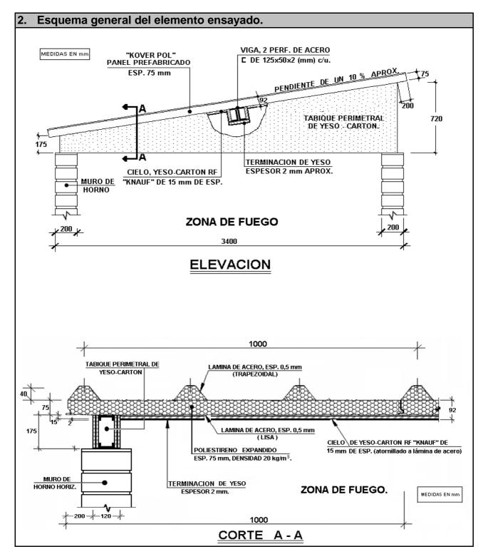
Nota: El elemento se dispuso inclinado para el ensayo en una superficie de 12 [m²].
