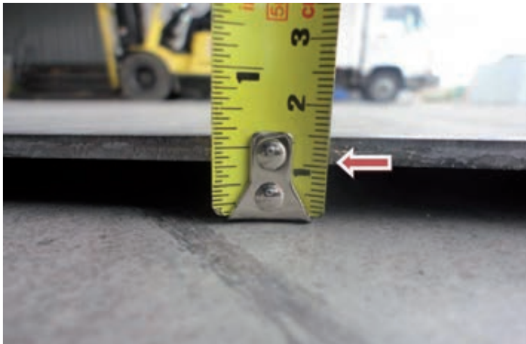
Figura 1: Forma correcta de medir la flecha de la plancha (ondulación)
