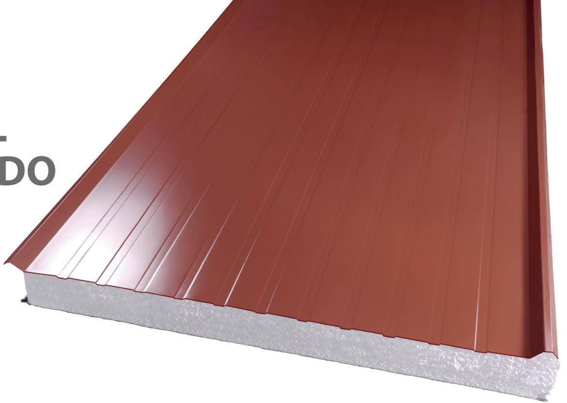
Panel Aislado 2V de Cintac®, está constituido por dos láminas de acero, con núcleo aislante de poliestireno de alta densidad (18-20 kg/m<sup>3</sup>, con tolerancia de  $\pm 2$  kg/m<sup>3</sup>), el cual constituye un elemento estructural auto-soportante de techumbre que cumple con las actuales reglamentaciones térmicas y de fuego.
