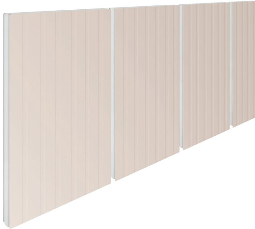
Panel constituido por dos láminas de acero, con núcleo aislante de poliestireno (POL) de alta densidad 18 – 20 kg/m<sup>3</sup>, (con tolerancia de ± 2 kg/m<sup>3</sup>), por lo que se obtiene una solución de muros o cielo aislado en un solo producto con excelentes propiedades térmicas.
