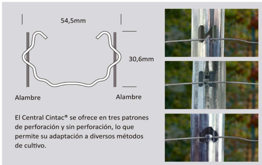
El Central Cintac® se ofrece en tres patrones de perforación y sin perforación, lo que permite su adaptación a diversos métodos de cultivo.
