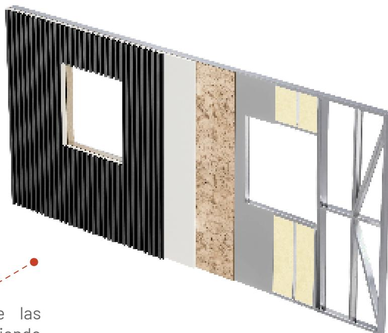
Solución Constructiva Cintac® basada en una estructura de perfiles metálicos de acero galvanizado Metalcon®, según Norma ASTM A653 SQ Gr40 y calidad Base de recubrimiento G60, estructura de 60, 90, 100 y 150 mm, y espesores 0,85 mm, 1 mm, 1,2 mm y 1,6 mm.
