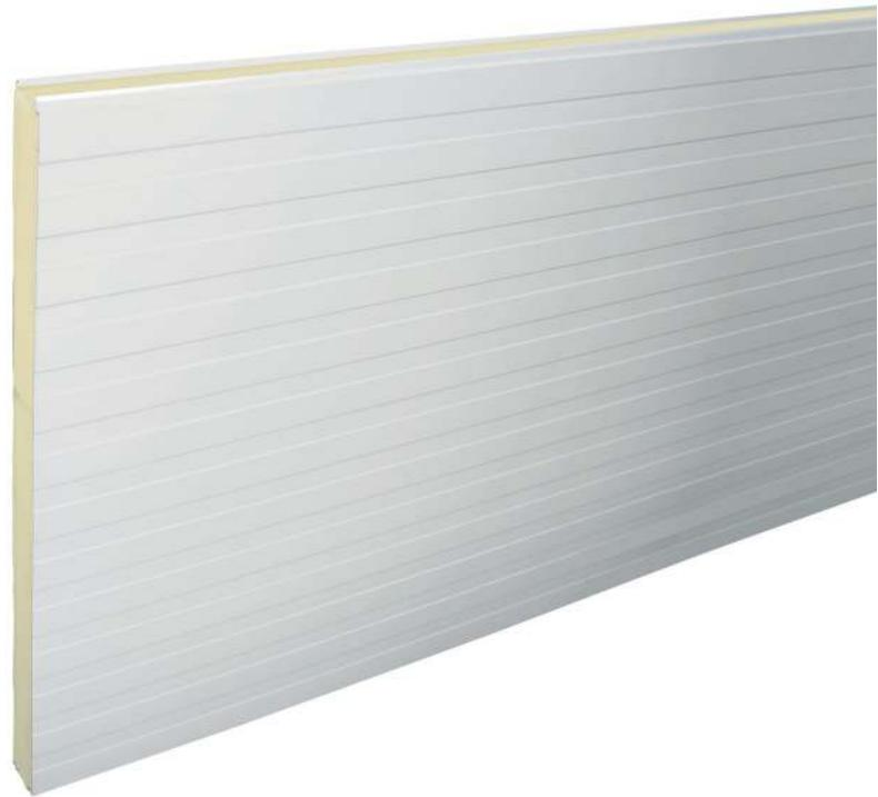
Panel continuo constituido por dos laminas de acero, con núcleo aislante de poliuretano (PUR) de alta densidad 38 a 40 kg/m (con tolerancia  $\pm 2$ ), por lo que se obtiene una solución de revestimiento aislado en un solo producto.
