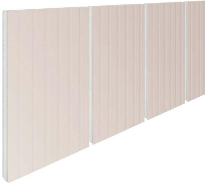
Panel constituido por dos láminas de acero, con núcleo aislante de poliestireno (POL) de alta densidad  $18 - 20 \text{ kg/m}^3$ , (con tolerancia de  $\pm 2 \text{ kg/m}^3$ ), por lo que se obtiene una solución de muros o cielo aislado en un solo producto con excelentes propiedades térmicas.
