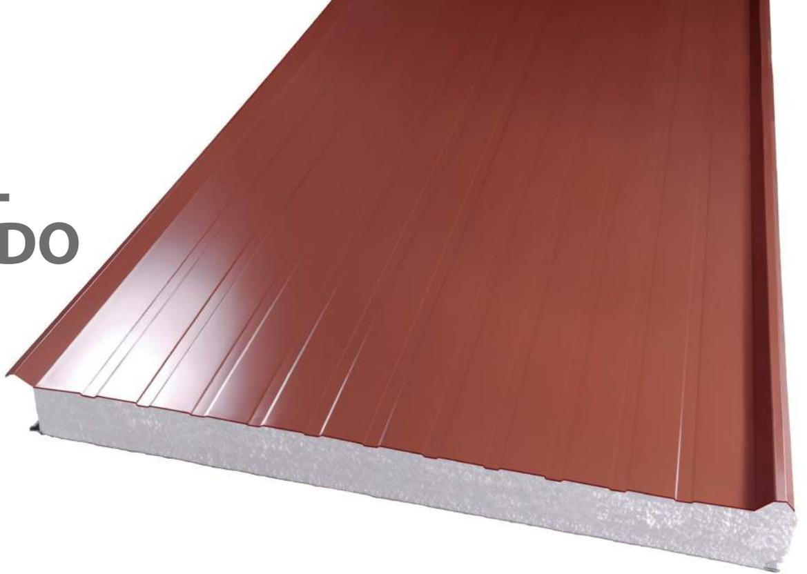
Panel Aislado 2V de Cintac®, está constituido por dos láminas de acero, con núcleo aislante de poliestireno de alta densidad (18-20 kg/m<sup>3</sup>, con tolerancia de ± 2 kg/m<sup>3</sup>), el cual constituye un elemento estructural auto-soportante de techumbre que cumple con las actuales reglamentaciones térmicas y de fuego.
