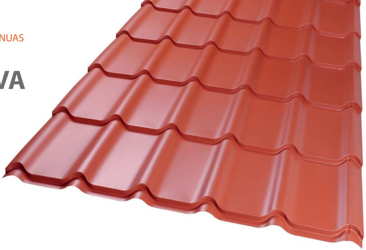
Teja Continua Curva Cintac® es una cubierta habitacional de acero de largo continuo, con claras ventajas estructurales y de estanqueidad. Su sistema de traslape lateral corta la filtración de agua por capilaridad.
